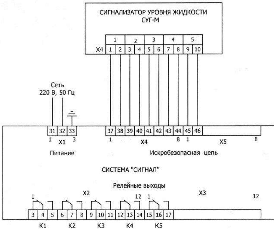
Рисунок 2 - Схема электрических подключений сигнализатора к системе “Сигнал”
