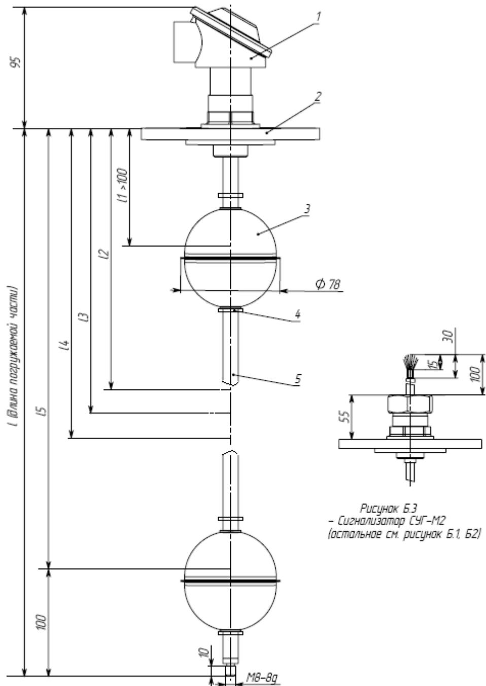
Рисунок Б. 2-Сигнализатор СУГ-М2-К с поплавком тип IV
