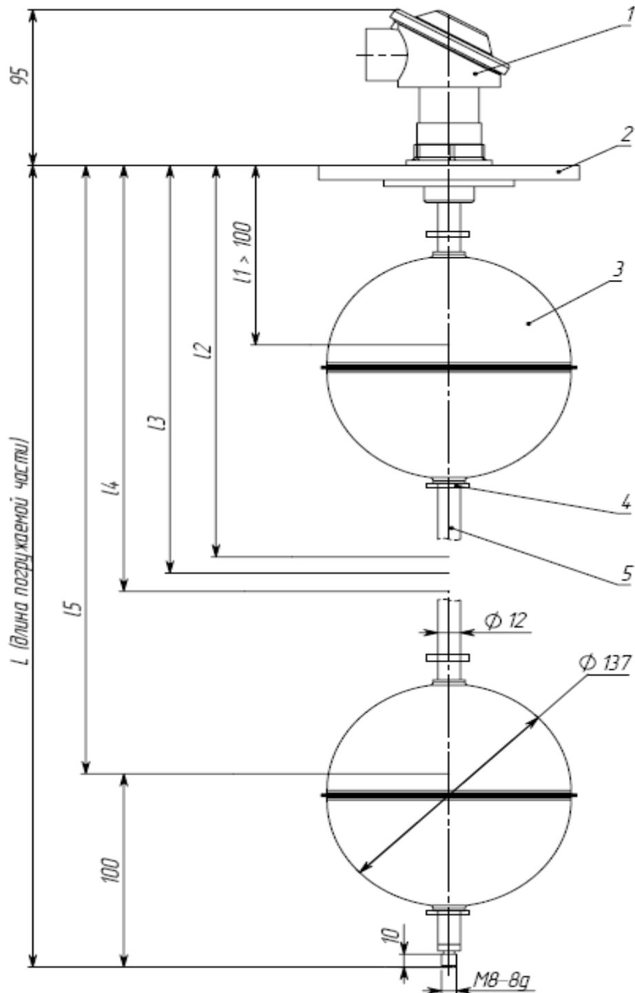
Рисунок Б.1 – Сигнализатор СУГ-М2-К с поплавком тип III
