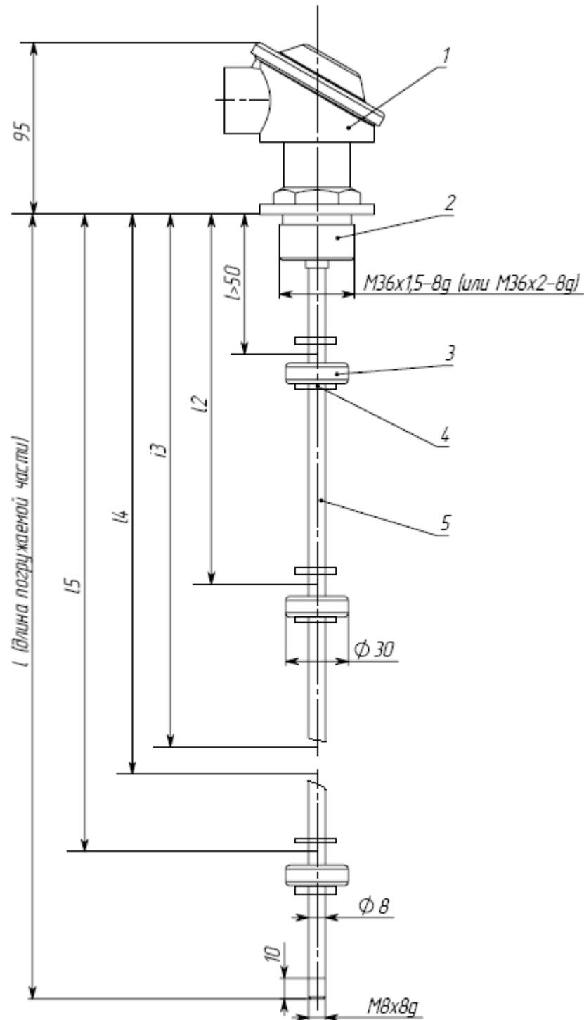
Рисунок А.2 – Сигнализатор СУГ-М1-К с поплавком тип I, крепление на емкости посредством штуцера
