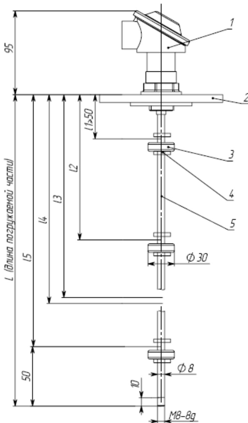
Рисунок А.1 – Сигнализатор СУГ-М1-К с поплавком тип I,
