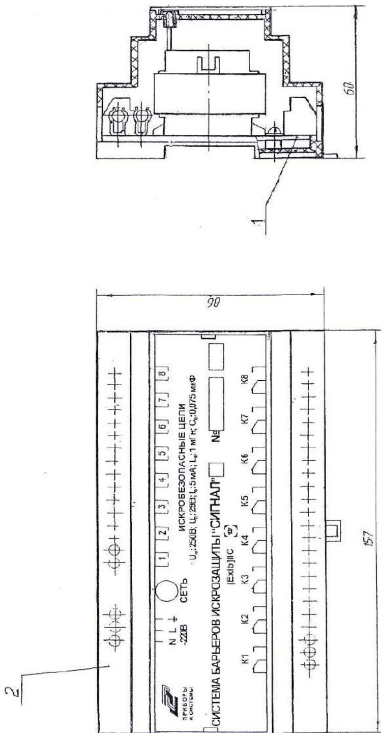
Рисунок 3 – Габаритные и установочные размеры системы “Сигнал”
