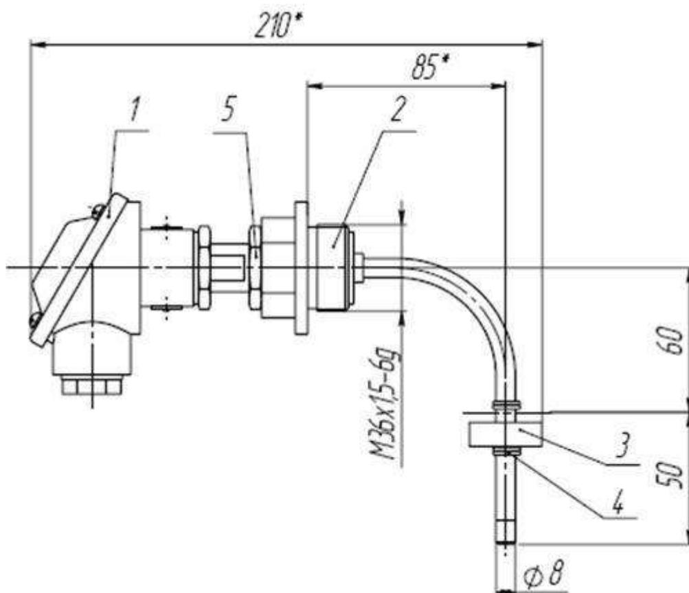
Рисунок Г.1- Сигнализатор СУГ-М1-К-Г с поплавком тип I крепление
